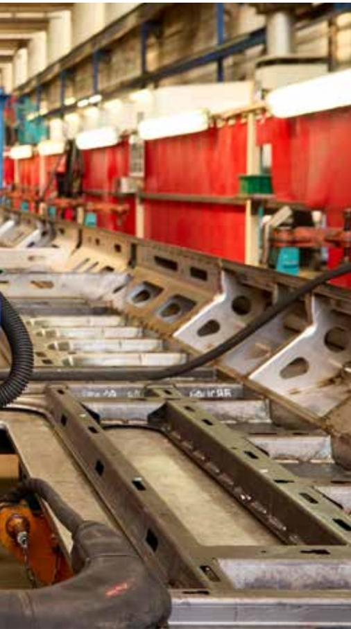
En ce moment, je travaille sur les montants de bout et les montants de porte. Et je découvre qu'il faut éviter les soufflures, ces petits trous qui peuvent apparaître dans le soudage!
